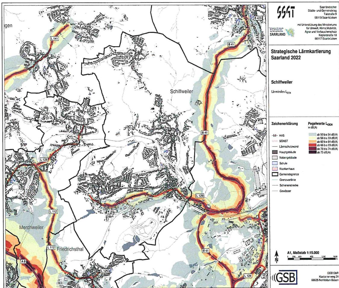
Abbildung 3: Gesamtbelastung Straßenverkehrslärm Gemeinde Schiffweiler, Lärmindikator  $L_{DEN}$
