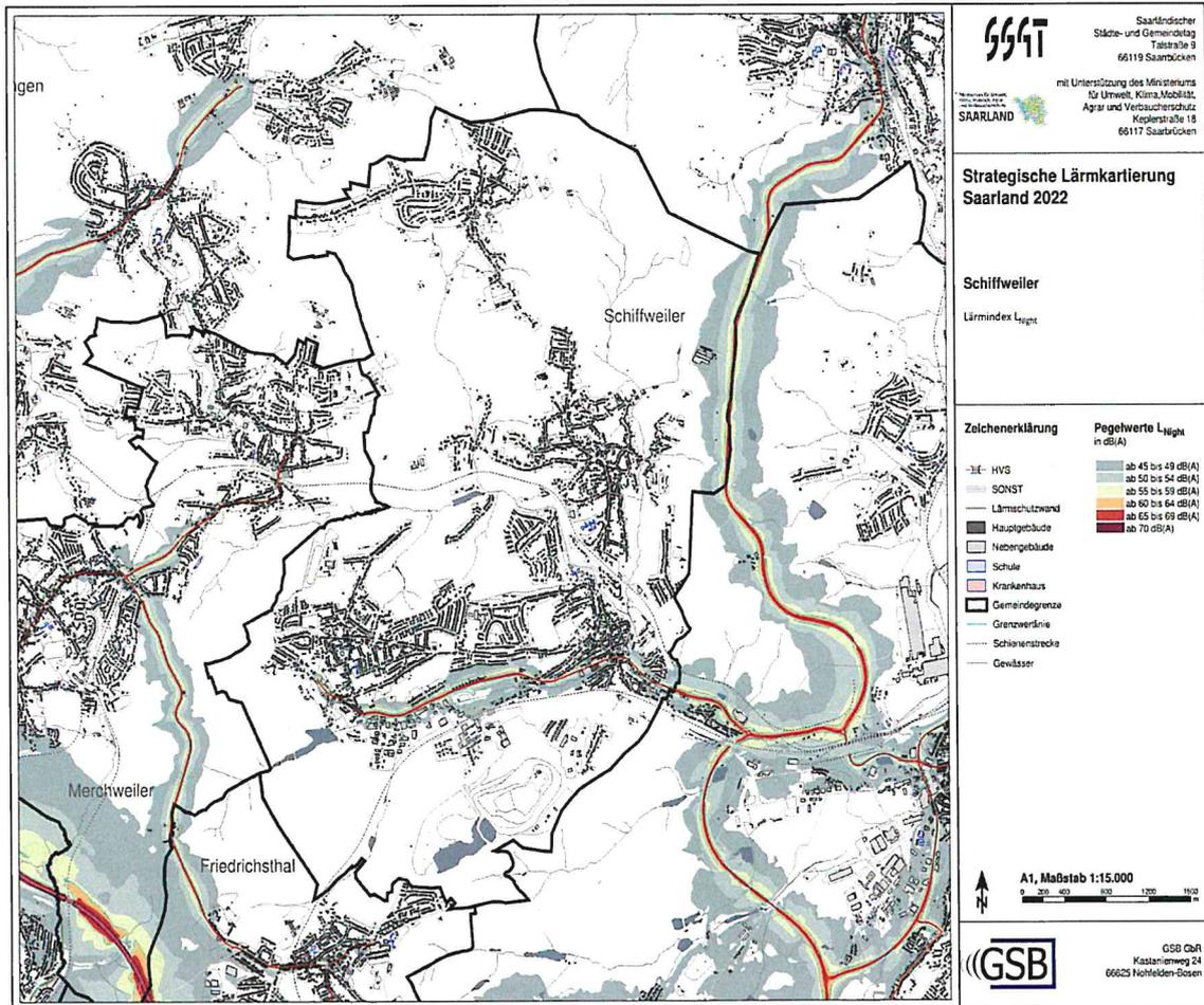
Abbildung 4: Gesamtbelastung Straßenverkehrslärm Gemeinde Schiffweiler, Lärmindikator L<sub>NIGHT</sub>
